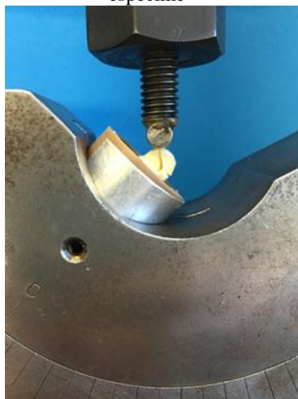
Figura 25 - Momento da fratura do espécime
