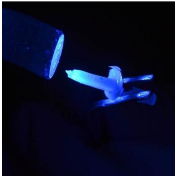
Foto 19 - Fotopolimerização 40 segundos por face
