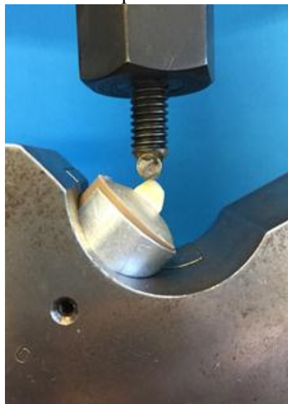
Foto 24 – Posicionamento dos corpos de prova em 45°
