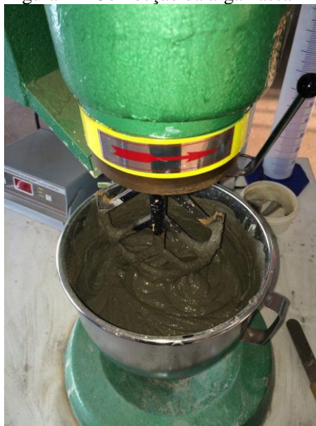
Figura 1 – Confeção da argamassa
