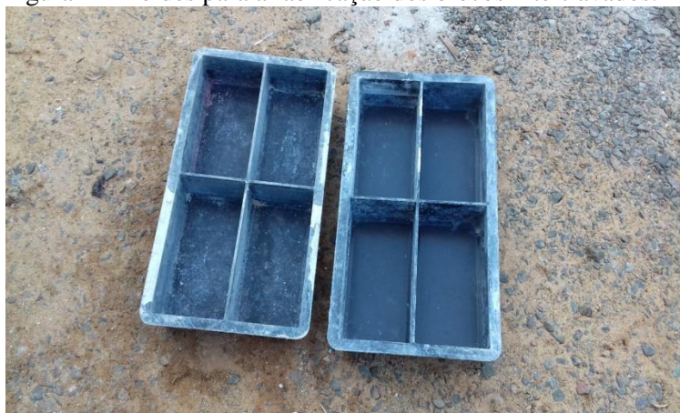
Figura 1 - Moldes para a fabricação dos blocos intertravados.
