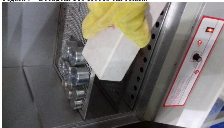
Figura 9 - Secagem dos blocos em estufa.
