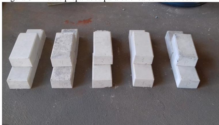
Figura 8 - Blocos preparados para os ensaios mecânicos.
