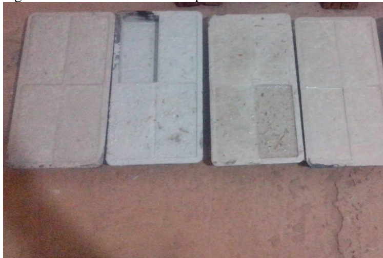
Figura 7 - Blocos moldados em processo de cura.
