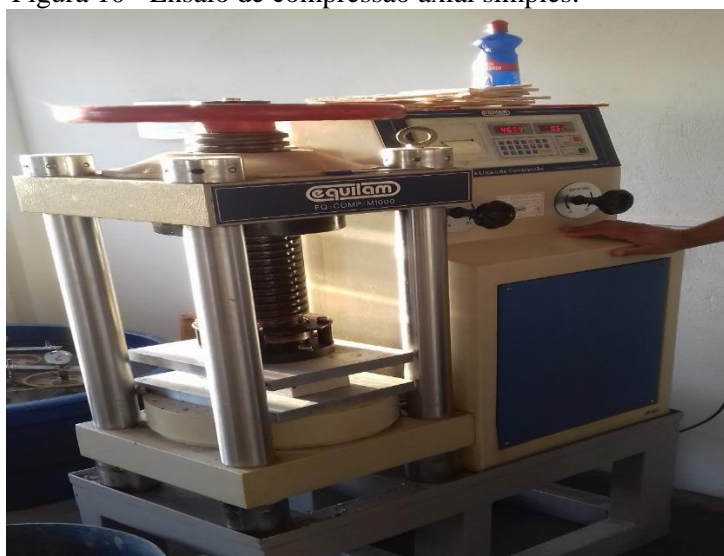
Figura 10 - Ensaio de compressão axial simples.
