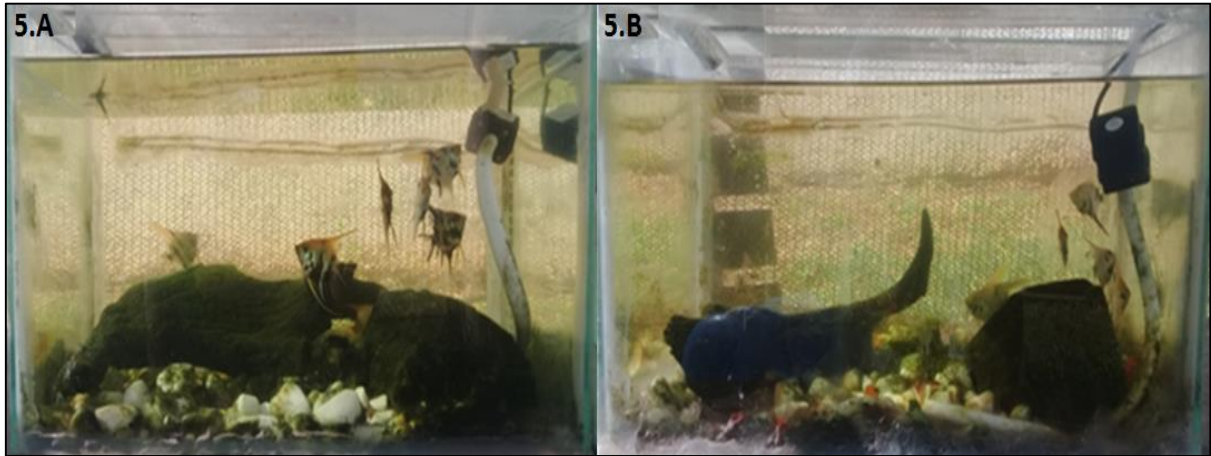
Figura 4–Turbidez observada no sistema com o filtro de garrafa Pet (5.A) e no sistema com o filtro de argila expandida (5.B) com 20 dias de funcionamento.
