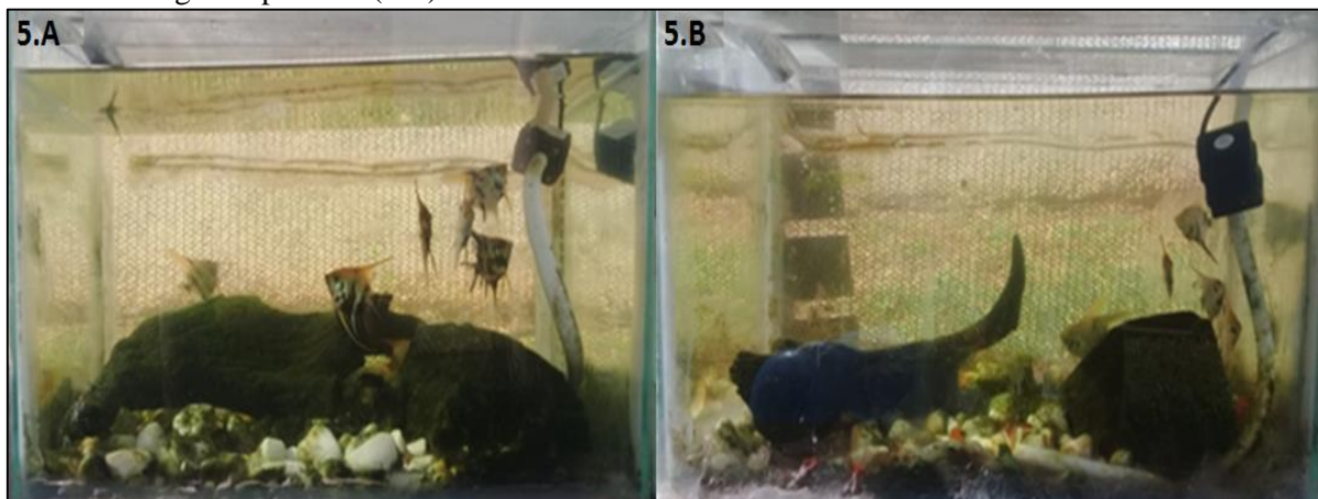
Figura 4–Turbidez observada no sistema com o filtro de garrafa Pet (5.A) e no sistema com o filtro de argila expandida (5.B) com 20 dias de funcionamento.
