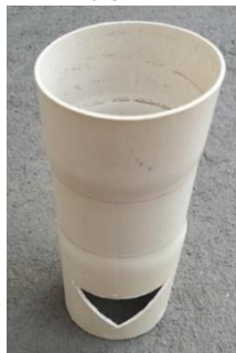
Figura 13 – Abertura do furo triangular na peça superior do filtro
