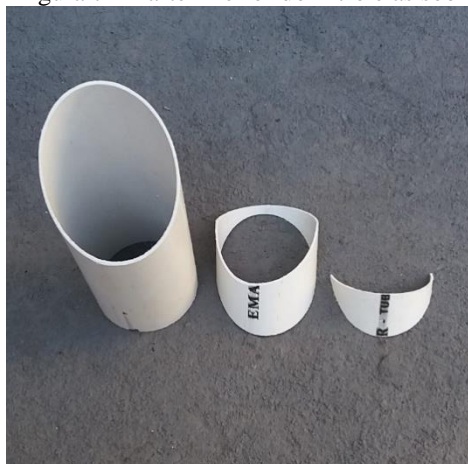
Figura 7 – Parte inferior do filtro e as sobras
