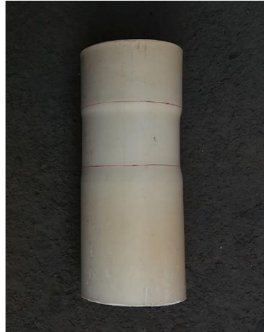
Figura 11 – Peça superior do filtro após a deformação das extremidades
