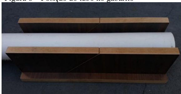
Figura 6 – Posição do tubo no gabarito
