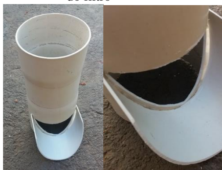
Figura 15 – Gotejador fixado na peça superior do filtro
