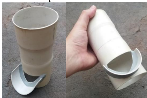
Figura 16 – Acabamento com epóxi na peça superior do filtro
