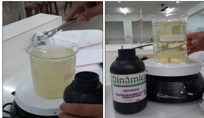
Figura 5 - Clarificação da água com o sulfato de alumínio.
