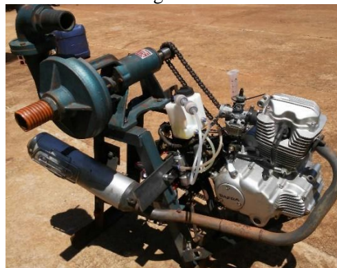
Figura 1- Conjunto motobomba movido a gasolina e hidrogênio
