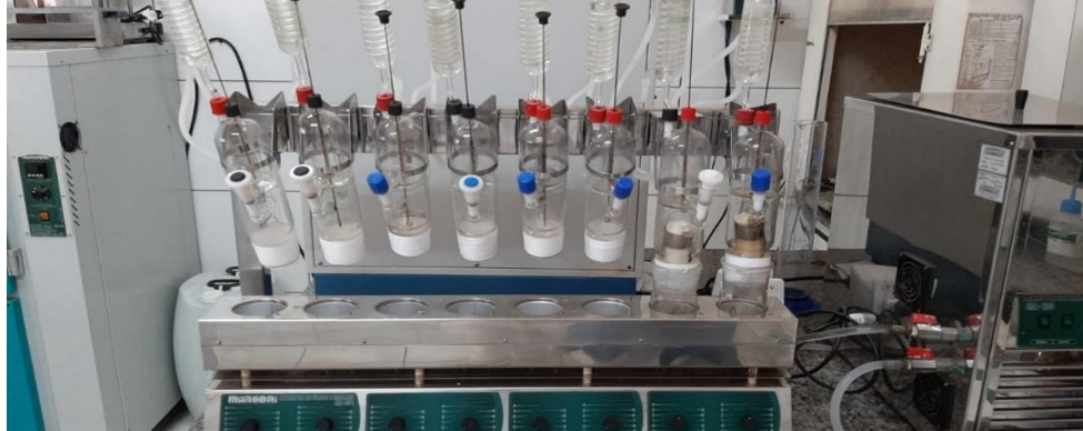
Figura 7 – Quantificação de lipídeos pelo Extrato Etéreo – Método a quente
