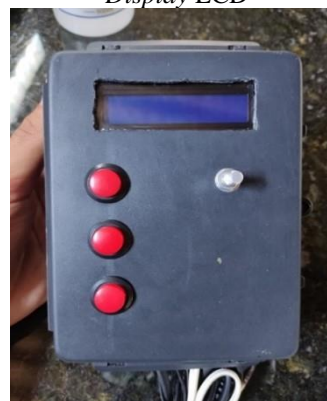
Figura 1 - Botões, Encoder e Display LCD
