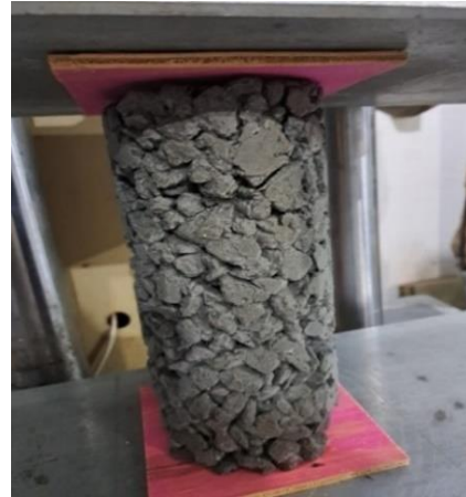
(b) Concreto Permeável
