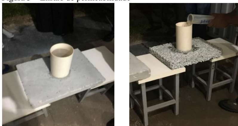
Figura 5 – Ensaio de permeabilidade
