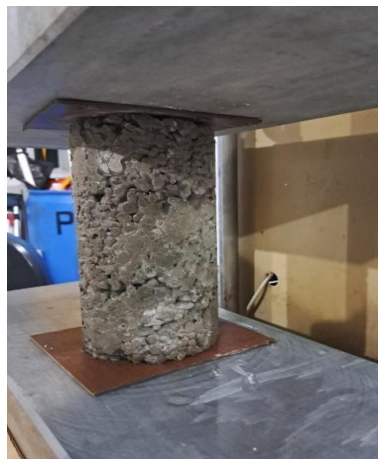
Figura 7 – Ensaio de compressão axial aos 7 dias
