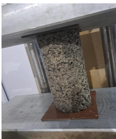
Figura 7 – Ensaio de compressão axial aos 7 dias
