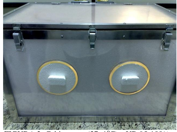
FIGURA 2: Cabine com (37\pm 1^\circ\text{C}) e UR 95-100%
