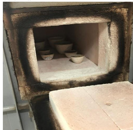
Imagem 6 – Processo de determinação de cinza
