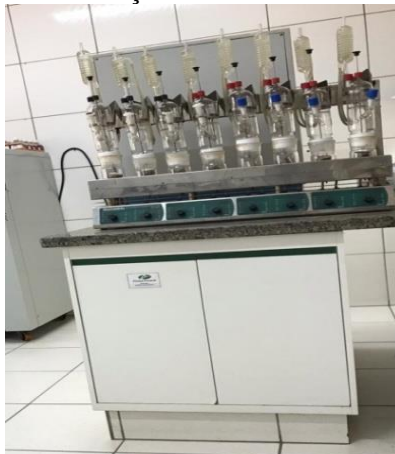
IMAGEM 7 – Processo de determinação de extrato etéreo
