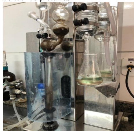
Imagem 4 – Processo de determinação do teor de proteínas
