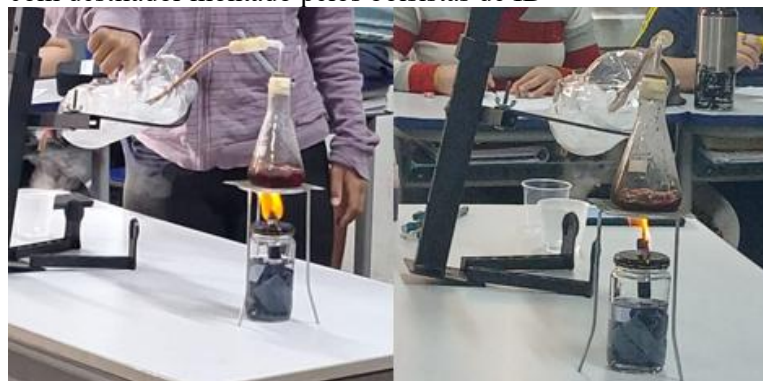
Figura 3 - Aula Prática acerca da destilação fracionada da água com destilador montado pelos bolsistas de ID
